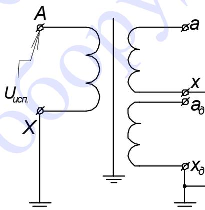
Рисунок Б.3 Схема испытания электрической прочности изоляции первичной обмотки трансформатора приложенным напряжением 1,3 номинального промышленной частоты
