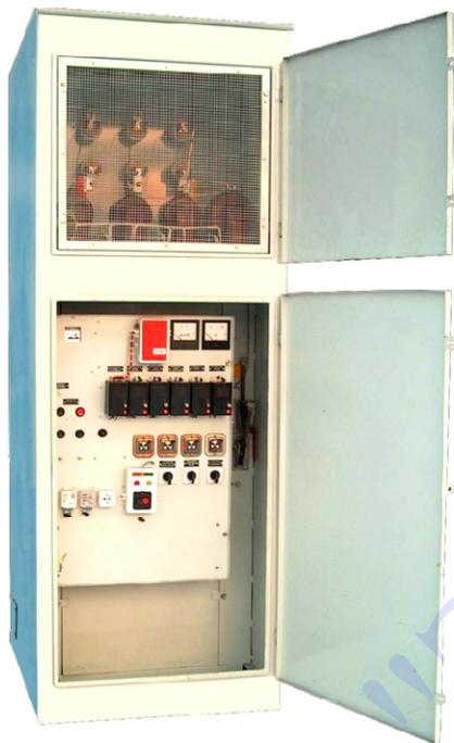
Предназначены для работы в сетях трёхфазного тока напряжением 6 (10)кВ, частотой 50Гц и используются для питания и защиты электрооборудования мощных карьерных электропотребителей, а также в составе комплектных распределительных пунктов комплекса буровых установок с лебёдками грузоподъемностью до 1600кН и секционных ячеек сельских электросетей.
