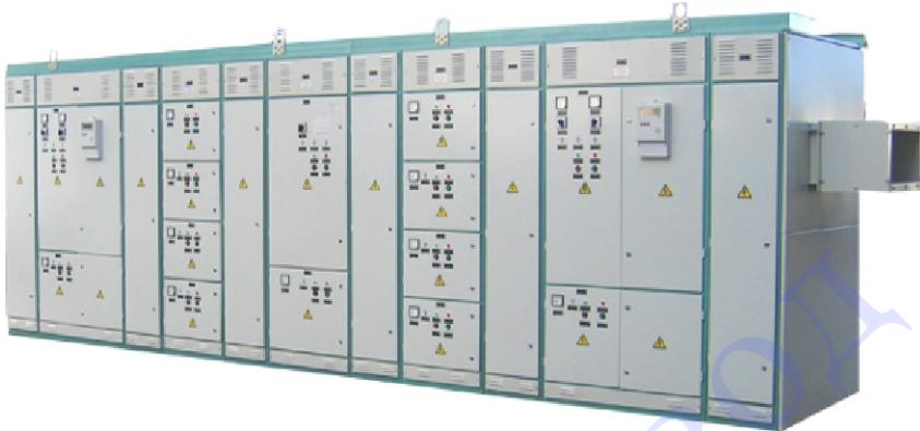
Комплектные трансформаторные подстанции внутренней установки предназначены для приёма, преобразования и распределения электрической энергии трехфазного переменного тока частотой 50 Гц. Настоящая техническая информация распространяется на комплектные трансформаторные подстанции внутренней установки мощностью от 250-2500 кВ•А на напряжение до 10кВ.
